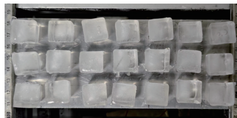
图 4 铝板表面冰分布实物图
