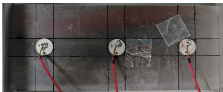
图 2 铝板上压电陶瓷布局实物图
