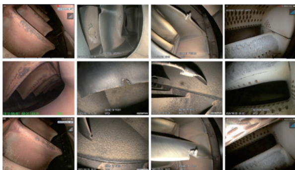
(a) Ablation (b) Nick (c) Tear (d) Crack
