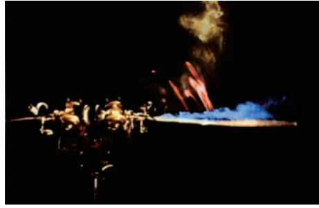
图 3 鹰蛾翅翼拍动模型上的失速涡 [13]
