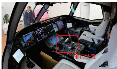
图1 油门装置及其在驾驶舱操纵台上的位置
