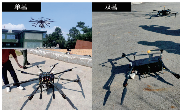
图3 本文使用的MiniSAR单基和双基系统实物图
