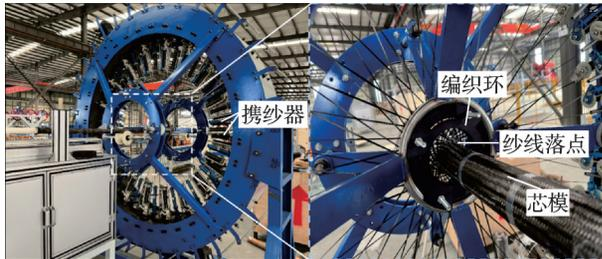
图2 连续式旋转编织设备
