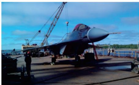
图3 米格-29K全机吊运图
