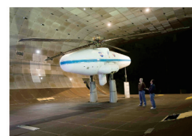
(d) Full scale UH-60A model in NFAC wind tunnel [90]
