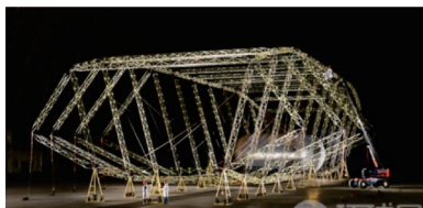
图1 新硬式飞艇骨架
