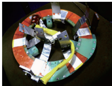
图5 Bi-2223/Ag双饼线圈模型 [41]
