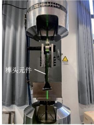
图 3 榫头元件低周疲劳测试布置
