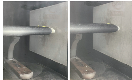
图13 风洞试验结冰图像
