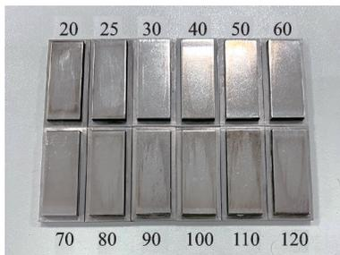
图15 相同电压、不同速度电解拉削出的工件图
