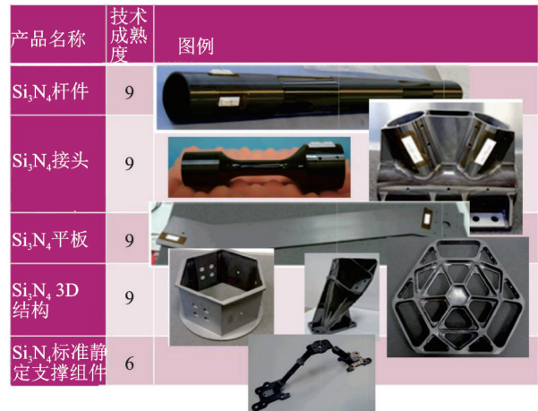
图4 氮化硅材料在空间光学望远镜结构中的应用 [59]
