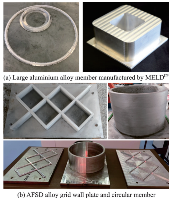
图 10 使用 AFSD 技术生产的大型构件
