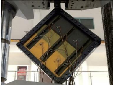
图 2 加筋壁板安装形式
