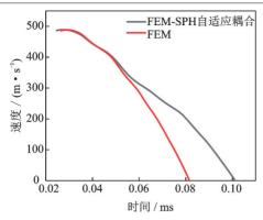
图 9 8 mm 蓝宝石面板弹丸侵彻速度对比
