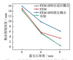
图 8 3 种计算模型后效靶剩余侵彻深度
