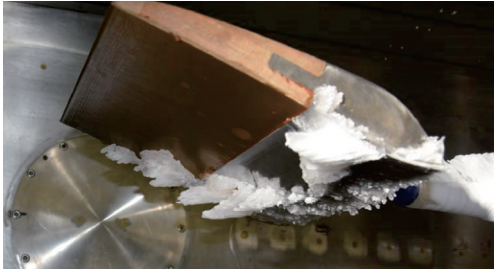
图10 个别试验工况出现溢流冰现象
