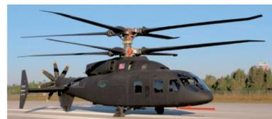
图4 共轴刚性旋翼直升机SB>1<sup>[15]</sup>
