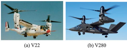
图10 倾转旋翼机V22和V280
