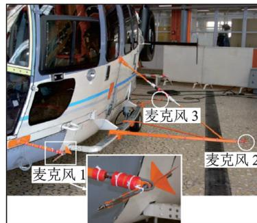
图13 EC155验证机上安装的麦克风<sup>[29]</sup>
