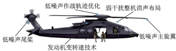
图 17 直升机外部噪声控制设计方案示意图
