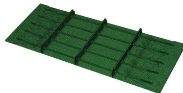
图2 无裂纹FEM
