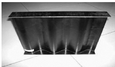
图 3 三波波纹腹板梁试验件照片
