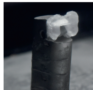
图12 传感器结冰情况(工况 ANTI_2,喷雾600 s结束后)
