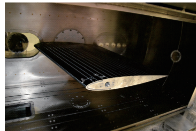
图4 试验模型在 FL-61 结冰风洞中的安装实物图
