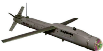
图17 美国雷神公司的伸缩翼方案 Fig.17 American Raytheon's telescopic wing solution
