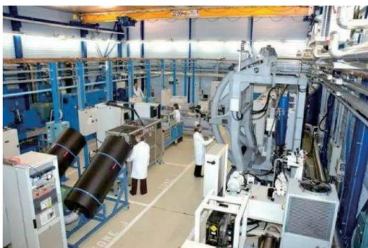
图 11 赛峰集团开发的铜鸟试验台<sup>[30]</sup>
