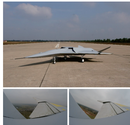
图 25 SMA 驱动可偏转翼梢小翼和后缘机翼飞行实验
