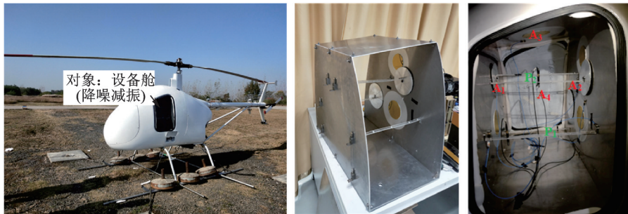
图 16 无人机设备舱声振测试
