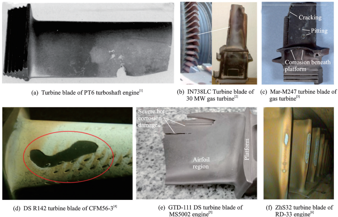
图1 涡轮叶片高温腐蚀失效案例
