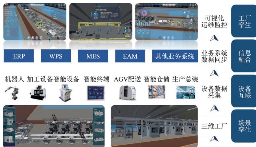
图1 面向生产过程的数字孪生系统体系架构
