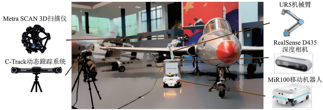
图 18 柔性测量系统与试验环境
