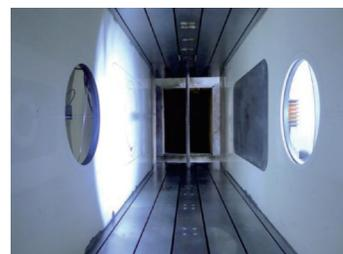
图 5 槽壁试验段
