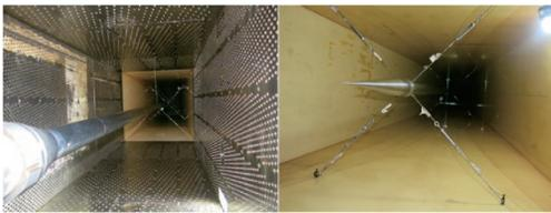
图1 某跨声速风洞中的长轴探管
