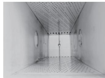
图 4 孔壁试验段
