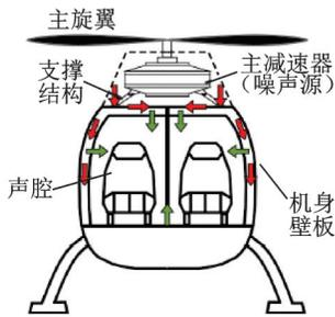
图1 典型直升机主减速器噪声源位置及其噪声传递示意<sup>[3]</sup>
