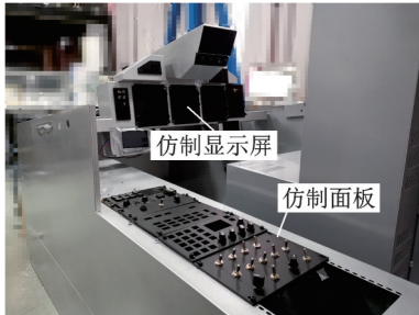
图5 仿制的航电检测模拟舱
