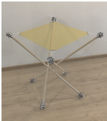
图1 典型的4杆张拉整体-薄膜系统
