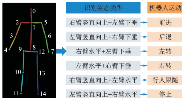
图4 不同姿态对机器人运动的控制关系
