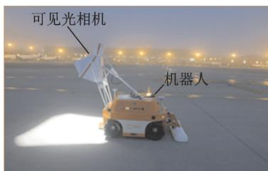
图 6 机场道面检测机器人
