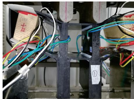
图6 试验件典型破坏模式
