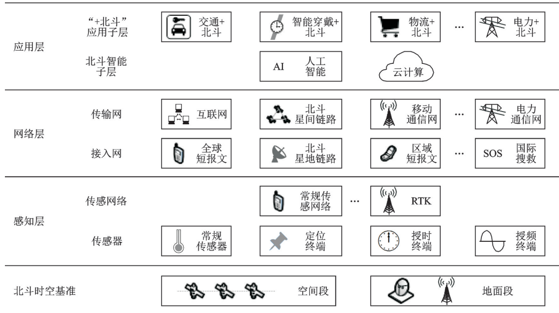
图 3 基于北斗系统的物联网技术架构示意图
