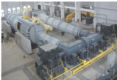
图 1 0.6 m 连续式跨声速风洞
