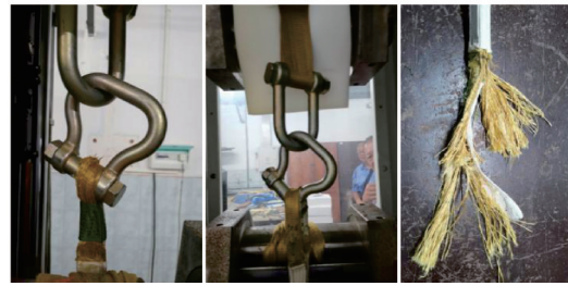
图 7 吊带非正常位置受力
