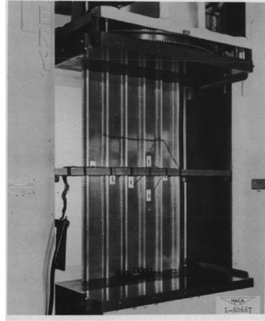
图4 Z形加筋板试验件
