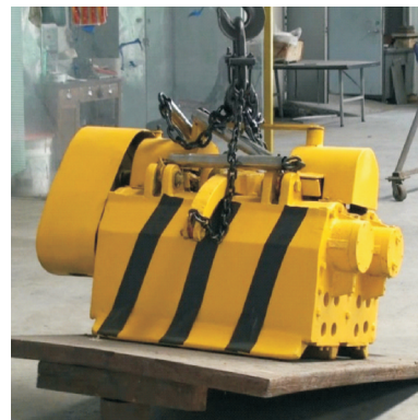
图 6 倾斜状态下吊装
