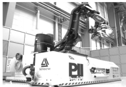
图3 弗劳恩霍夫协会的机器人铣削系统
