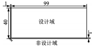
图 7 机翼结构拓扑优化设计模型(单位:mm)
