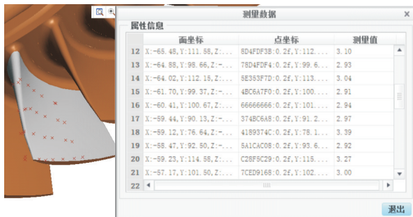
图18 加工余量的检测
