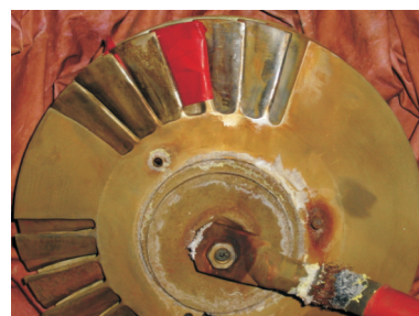
图 17 多个叶片的开粗加工结果
