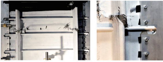
图 39 受压壁板试验件两侧支撑结构 [55]
