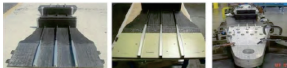
图35 受拉壁板试验夹具安装 [55]
