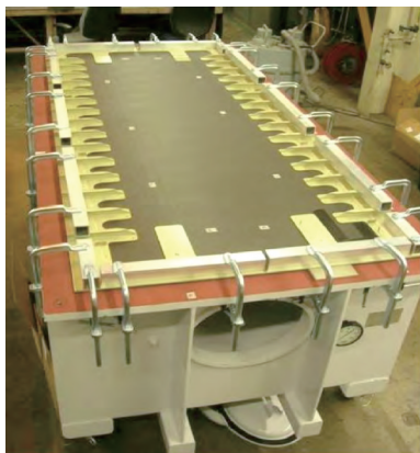
图31 铝合金夹具固定后的壁板 [64]
