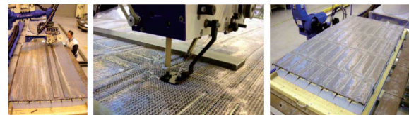
图25 隔框和长桁组件与蒙皮缝合 [55]
