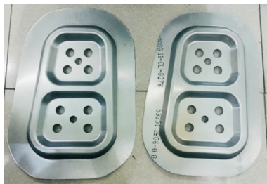
图 18 冲击液压成形制备的航空复杂曲面钣金构件
