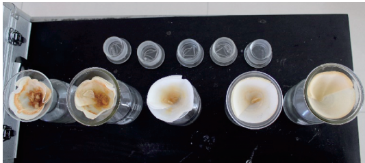
图 2 不同清洗剂下锂基润滑脂的清洗效果图(从左至右依次为煤油、汽油、洗涤剂、稀释剂、新型清洗剂)
