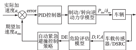
图 6 车辆避撞控制基本框架图
