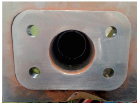
图 10 部件 B 对接面基准孔特征提取加工实验
