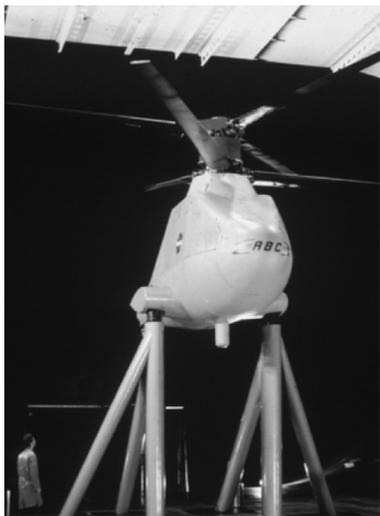
图1 NASA AMES 40 ft×80 ft 风洞全尺寸共轴刚性旋翼风洞试验
