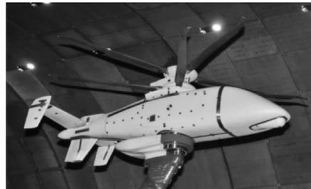
图2 NASA AMES 40 ft×80 ft 风洞共轴刚性旋翼缩比模型风洞试验
